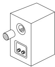
Il livello delle basse frequenze dei diffusori Nota-X da scaffale può essere interfacciato con l'acustica della stanza inserendo nel condotto reflex il tampone di spugna in dotazione.
