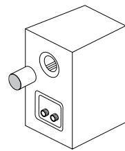
È possibile interfacciare il livello delle basse frequenze con le caratteristiche della stanza, semplicemente inserendo nel condotto reflex il tampone in dotazione a DIVA 252 e 752.
