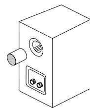
Inserendo nel condotto reflex il tampone in dotazione a TESI 242 e TESI 742, è possibile interfacciare le basse frequenze con la stanza.
