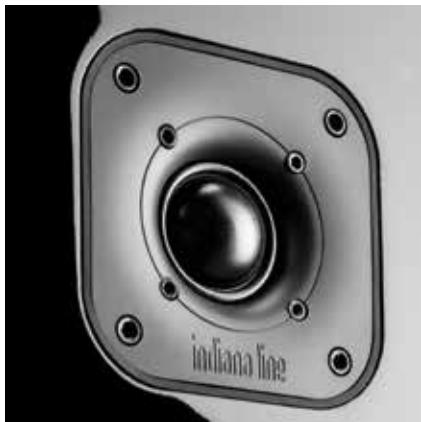
I tweeter Diva sono montati sul diffusore tramite un guscio di disaccoppiamento in gomma morbida, che rende virtualmente "flottante" il componente: si ottiene così una sensibile riduzione delle vibrazioni trasmesse dal mobile al tweeter stesso. La corretta escursione della cupola è controllata da una camera di risonanza radiale, provvista di due diversi tipi di assorbente acustico, inseriti sotto la cupola ed all'interno dell'anello di ventilazione.
